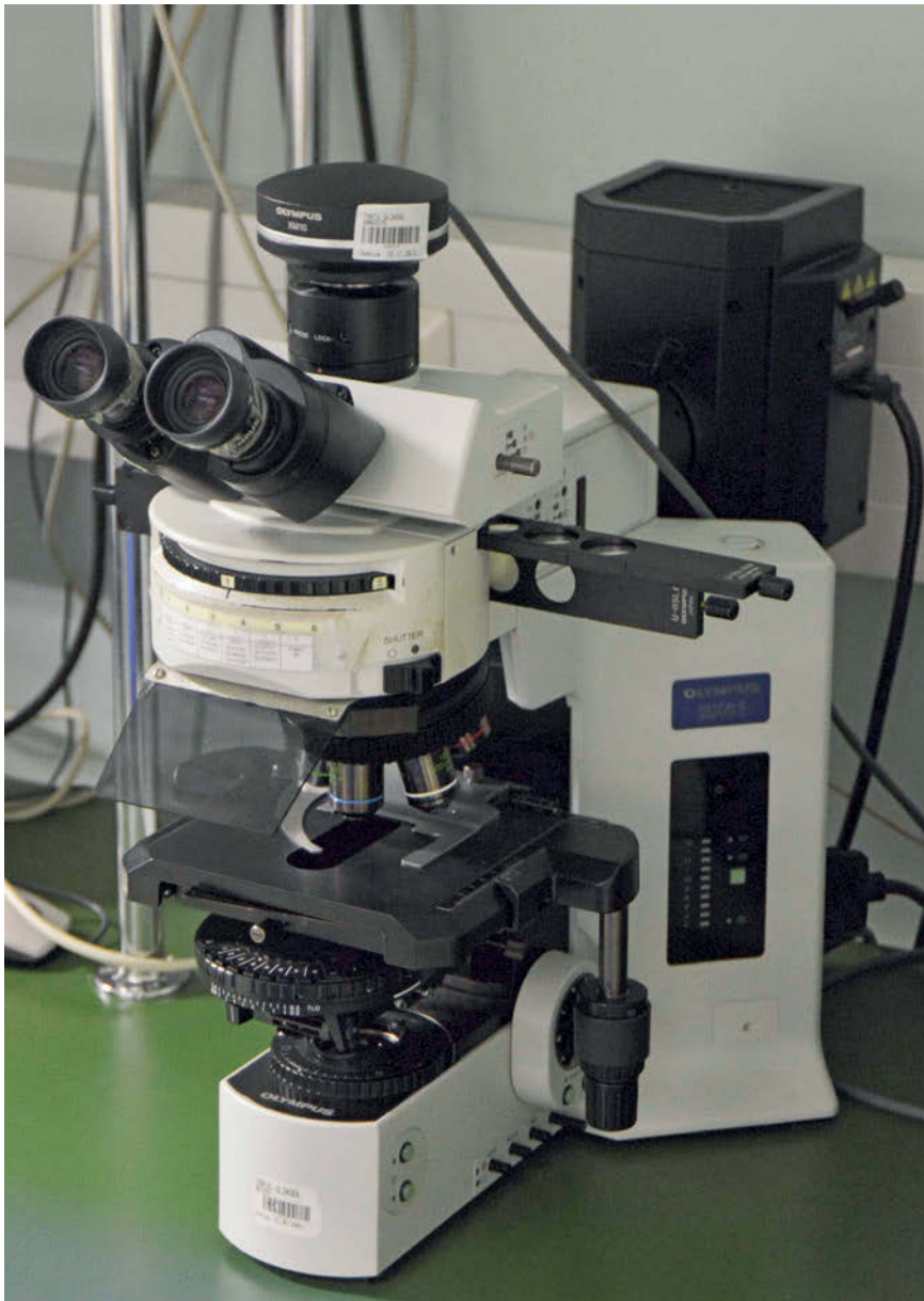
◇ 7. Nüüdisaegsem Olympuse BX61 pealtvalgustusega mikroskoop, millel on ka ultravioletvalguses objektide vaatamise filtrid ja vastavad objektiivid. Suurendab 40 kuni 1000 korda
