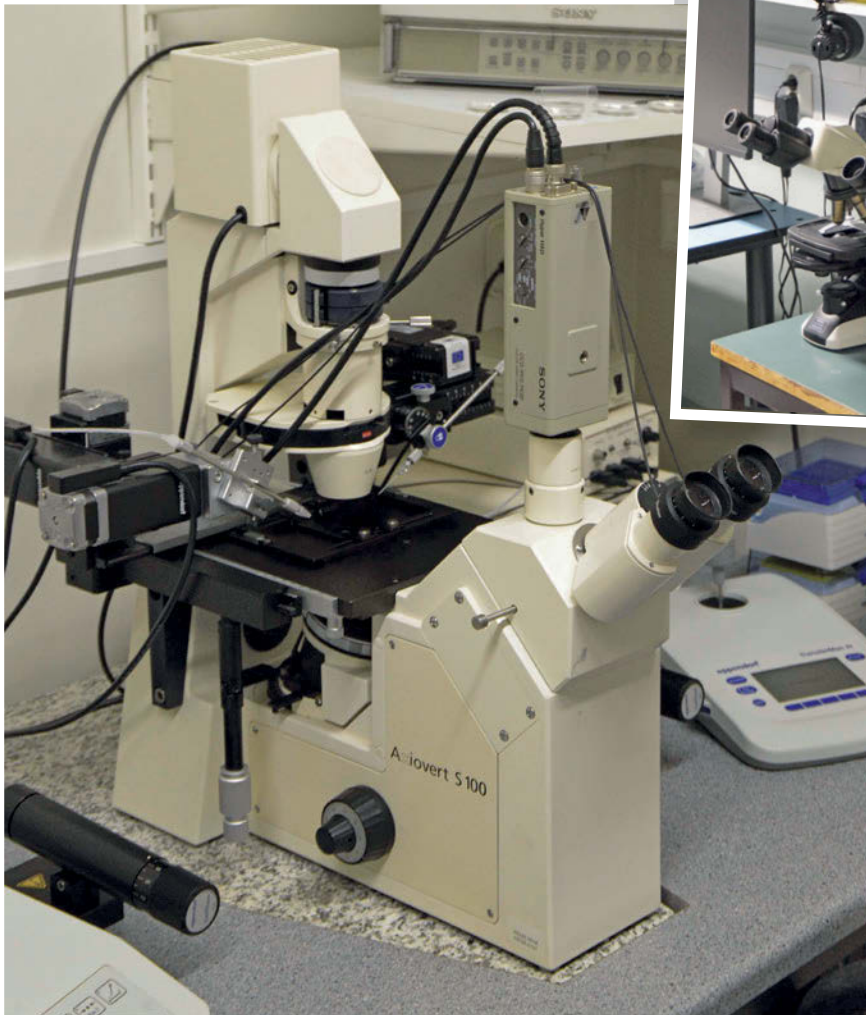
◇ 6. Eri tootjate invertmikroskoobid: vasakul Zeiss Axiovert 100S, mis on mõeldud mikrotoiminguteks (nt rakkude süstimine, blastotsüsti injeksioon jt); paremal Nikon Diaphoti klassikaline invertmikroskoop. Mõlemad suurendavad kuni 400 korda
