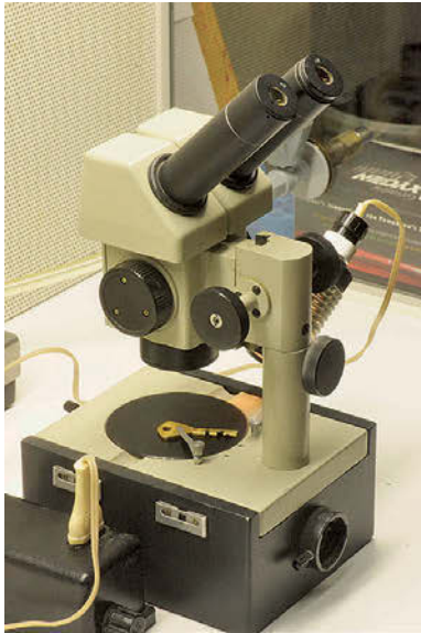
◇ 5. Stereomikroskoopide näidised. Vasakul 40 aastat tagasi NSV Liidus toodetud binokulaar ehk stereomikroskoop MBC-9 (suurendab 4,8 kuni 56 korda) ja paremal nüüdisaegne stereomikroskoop Leica M165 FC (suurendab 7,3 kuni 120 korda), mis võimaldab ka digitaalset töötlust
